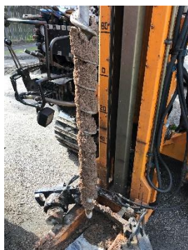
Figur 5. Karaktären på fyllnads materialet är generellt inom undersökt område grusig sand med inslag av större sten.
