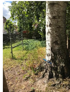
Figur 10. Träprovtagning i CWM07. Träkärnan uttogs 0,5 meter över markytan på en björk. Provet uttogs i riktning mot föroreningen. Bilden är tagen åt söder.
