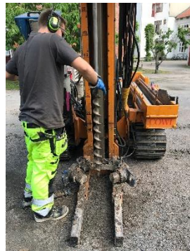
Figur 9. Mellan varje provtagningspunkt rengjordes skruven med svamp och vatten.
